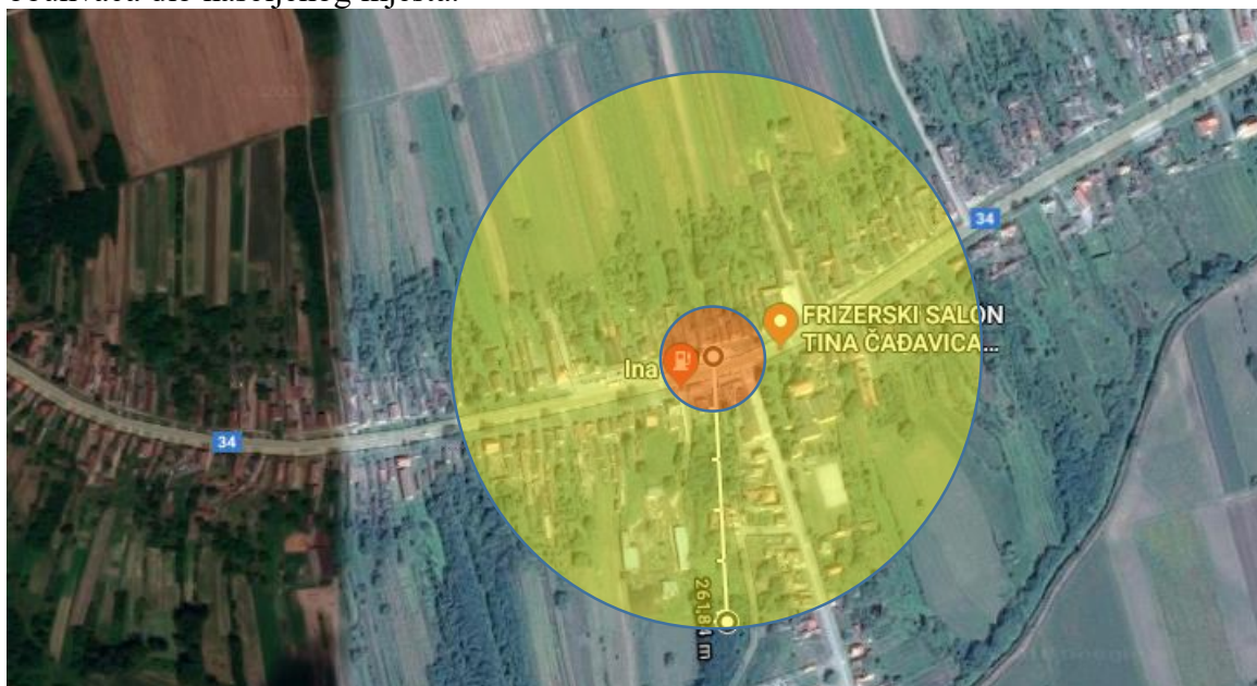
Slika 11: Radijusi ugroze te radijus smrtnosti (crveno) u slučaju akcidenta kod pretakanja goriva Izvor podataka: http://preglednik.arkod.hr/ ; Planovi i Procjene j.d.o.o.
